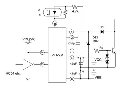
V<sub>CC</sub> = 15V V<sub>EE</sub> = 10V
